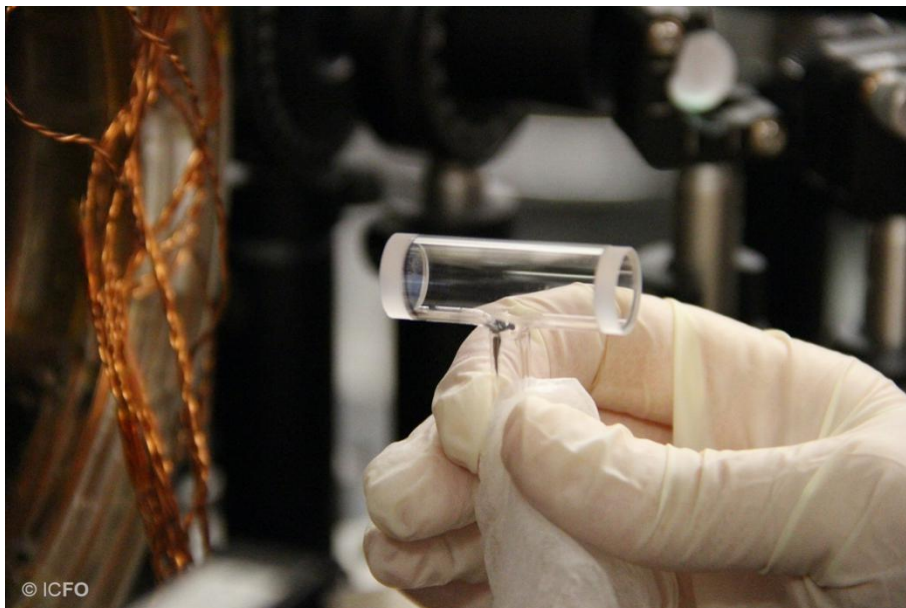
Llegenda: Imatge de la cel·la de vidre on es barreja el metall de rubidi amb gas nitrogen i s'escalfa fins a 450 graus Kelvin. A aquesta temperatura alta, el metall es vaporitza i crea àtoms de rubidi lliures que es difonen dins de la cèl·lula. Crèdit de la imatge: © ICFO
